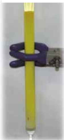
希薄水溶液からのCr(VI)の連続除去装置
