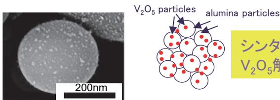
シンタリングしないV<sub>2</sub>O<sub>5</sub>触媒粒子
