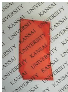
スピロピランを20 mass%以上含有し、濃く着色したシリカ膜
