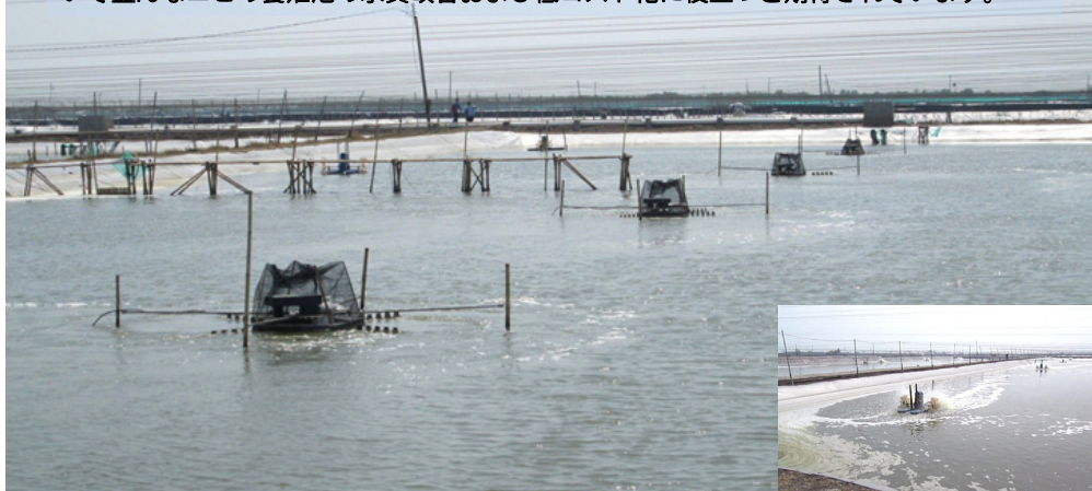
5,000m 2 の池に遠心式攪拌機を並列で4台設置した実用テストの様子 (右下) 同規模池に大出力の水車式攪拌機を10台設置している様子
