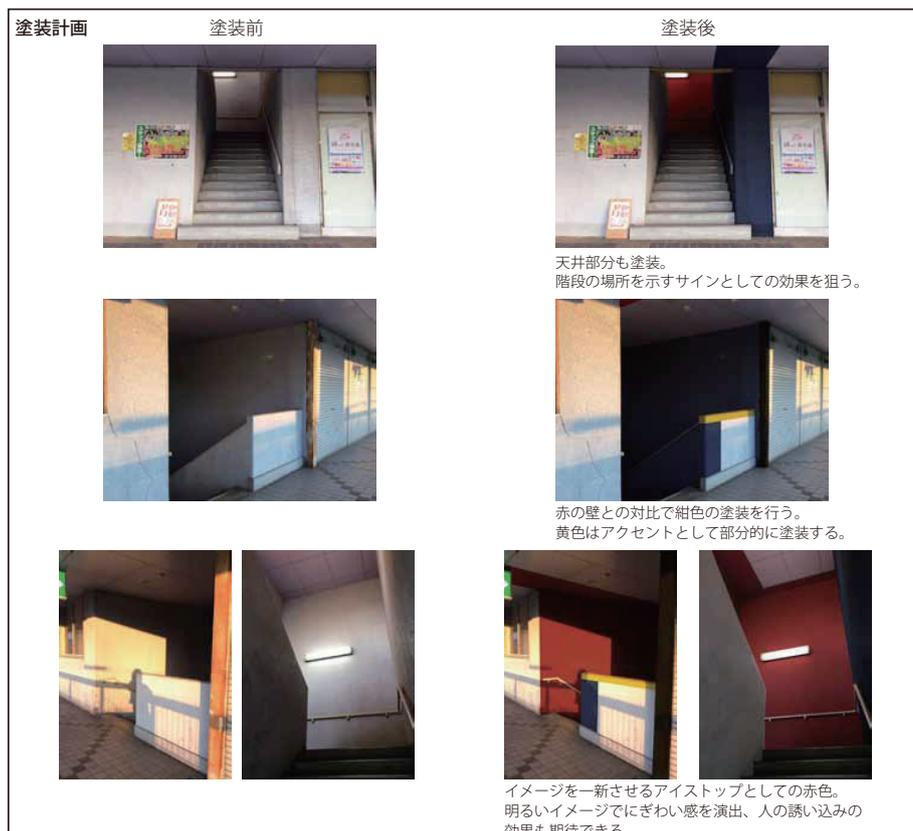
図3. 外部階段の塗装
