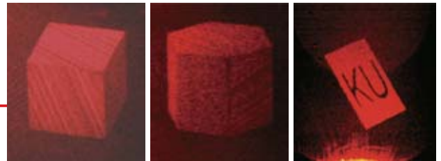
ポリゴンによる表面モデルのデジタル合成ホログラムの再生像
