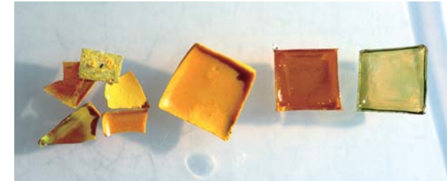
原田准教授が開発した、高い放熱性を持つエポキシ樹脂
