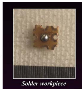
削られる素材(半球部分)。基板の大きさは一辺約3ミリメートル▶
